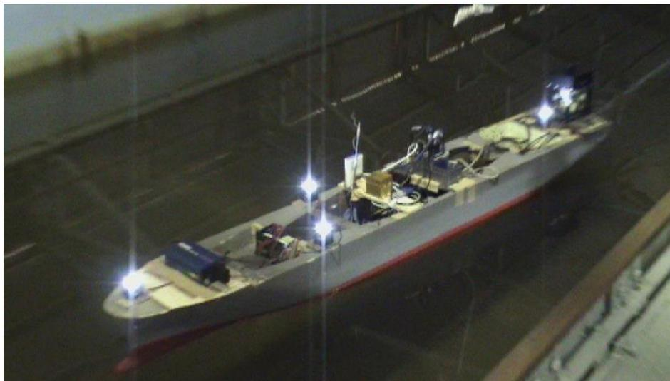
模型船搭載状態 (Z試験)
